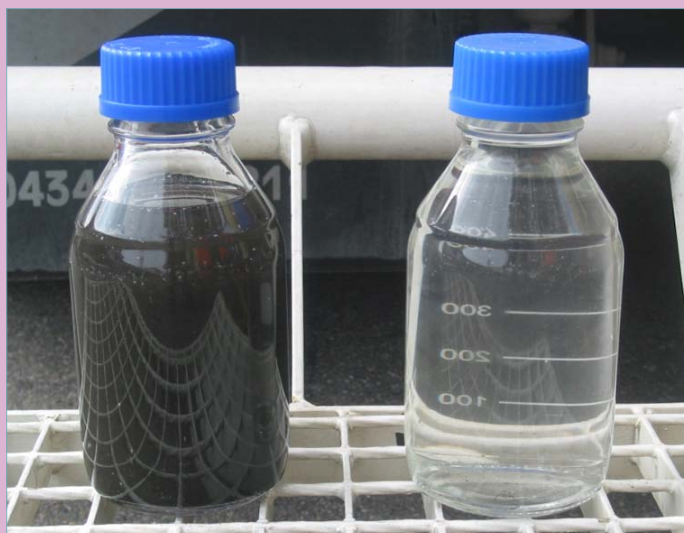
Unbehandeltes Abwasser (links) und mobil aufbereitetes Abwasser von Strassensammlern.
